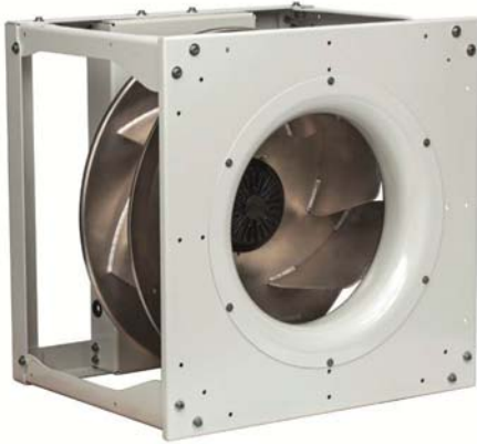
Рис. 2: Серия RadiPac доступна с мощностью привода от 500 Вт до 12 кВт и внешним диаметром от 250 мм до 1250 мм
