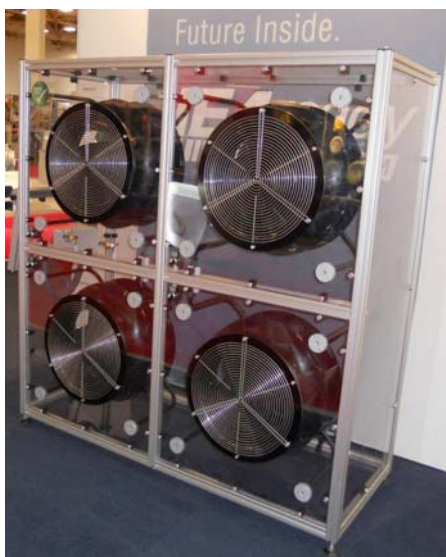
Мал. 1: Природне охолодження в обчислювальному центрі. Центральний елемент - це так званий Fan-Array, в даному випадку експонат виставки.
